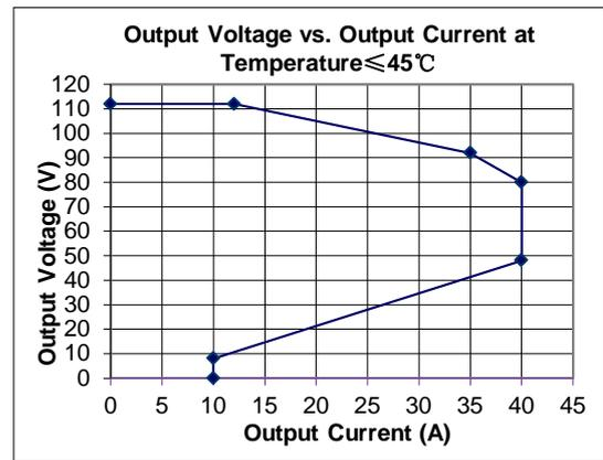
图 6 HZDI80V40A-II 输出 V-I 曲线
