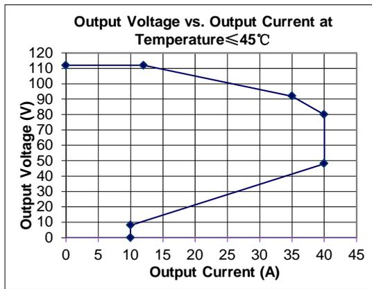
图 5 HZDI100V25A-II 输出 V-I 曲线
