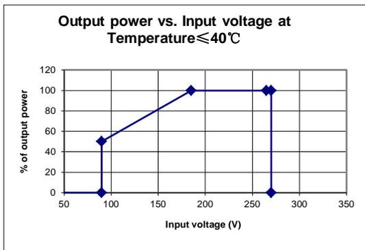
图1 输入限功率曲线
