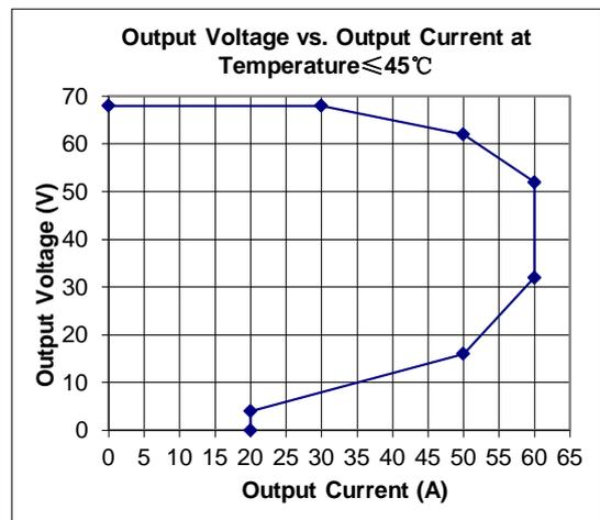
图4 HZDI60V50A-II 输出 V-I 曲线
