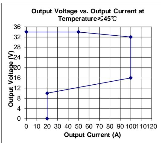
图3 HZDI30V100A-II 输出 V-I 曲线
