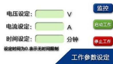
在此界面输入输出电压, 输出电流以及工作时间。输入完毕后按“启动工作”键确认, 充电机将进入工作状态, 送出继电器吸合信号, 进入运行状态监控界面。当系统检测到正常输入电压后主接触器吸合, 电源开始工作, 此时在此界面将显示“电池电压”、“充电电流”和“故障信息”等参数, 一旦出现故障后在故障信息栏将显示相应的故障内容。
