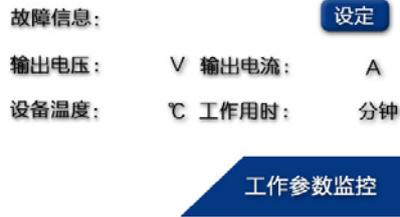
**远程模式：**，将面板模式开关打到“远程”的位置，打开电源总开关，屏将直接进入监控界面，通过 485 通信得到相应的输出电压输出电流。
